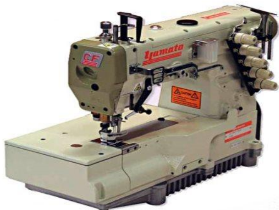
Рис.1 Пятиниточная плоскошовная швейная машина
